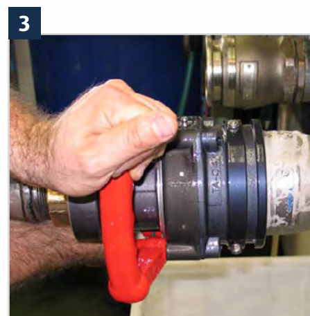
90° weiterdrehen bis Anschlag - volle Durchströmung
