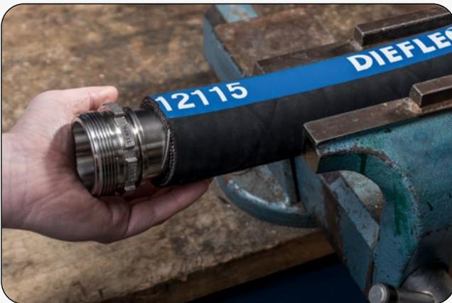
3. Den Schlauchstutzen von Hand oder unter Zuhilfenahme eines Gummihammers bis zum Kragen in den Schlauch schieben.
