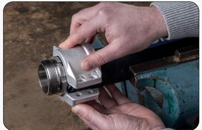
4. Die beiden Klemmbacken Hälften um den Schlauch legen. **ACHTUNG:** Hierbei ist auf den korrekten Sitz der Klemmbacken hinter dem Kragen des Stutzens zu achten.
