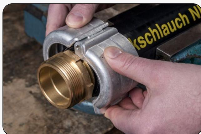
4. Die aufgeklappte Klemmschale um den Schlauch legen und soweit wie möglich von Hand zusammendrücken. **ACHTUNG:** Hierbei ist auf den korrekten Sitz der Schale hinter dem Kragen des Schlauchstutzens zu achten.
