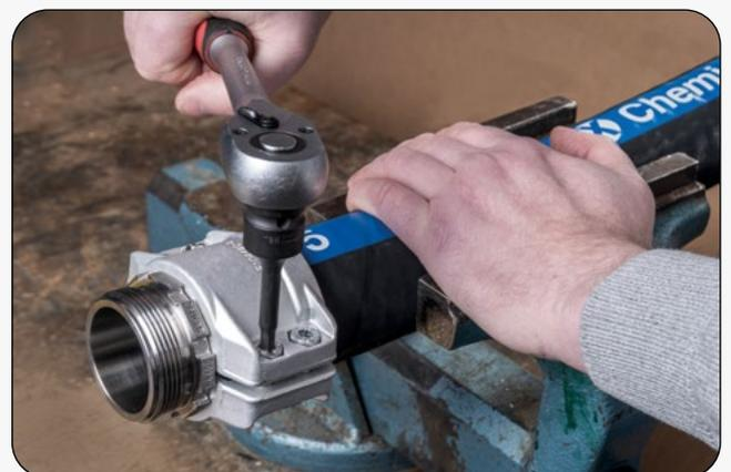
6. Die Schrauben und Muttern nun gleichmäßig fest ziehen und beiderseits auf gleiche und parallele Abstände zwischen den Klemmbackenhälften achten!
