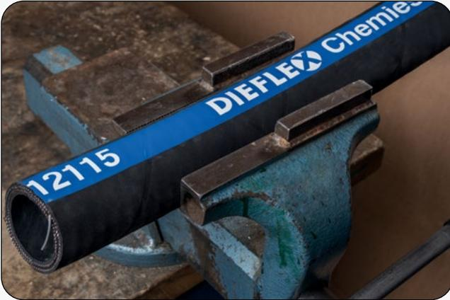
1. Das rechtwinklig abgeschnittene Schlauchende sorgsam in einen Schraubstock einspannen.
