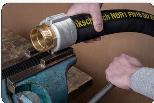
5. Die Klemmschale nun gleichmäßig im Schraubstock zusammendrücken.
