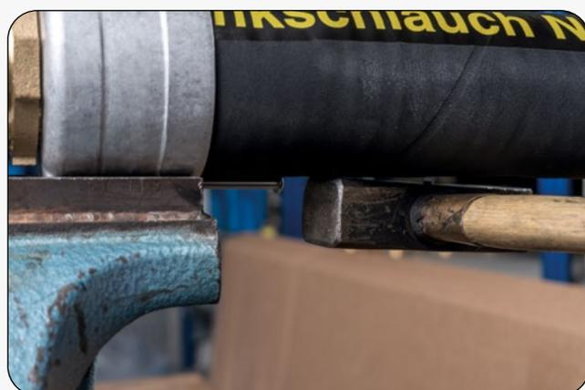
6. Den Niet mit einem Hammer bis zum Anschlag einschlagen. Der Schlauchstutzen ist nun mit Schale und Schlauch fest verbunden.
