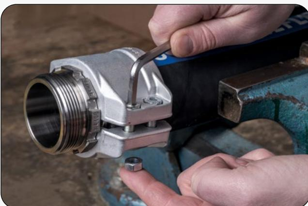
5. Die Klemmbacken nun mit den mitgelieferten Schrauben und Muttern verschrauben. Ggf. auch unter Zuhilfenahme von über Kreuz geschraubten Montageschrauben.
