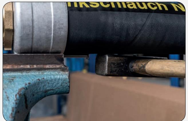
6. Den Niet mit O-Ring mit einem Hammer bis zum Anschlag einschlagen. Der Schlauchstutzen ist nun mit Schale und Schlauch fest verbunden.
