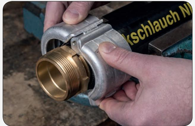
4. Die aufgeklappte Klemmschale um den Schlauch legen und soweit wie möglich von Hand zusammendrücken. **ACHTUNG:** Hierbei ist auf den korrekten Sitz der Schale hinter dem Kragen des Schlauchstutzens zu achten.
